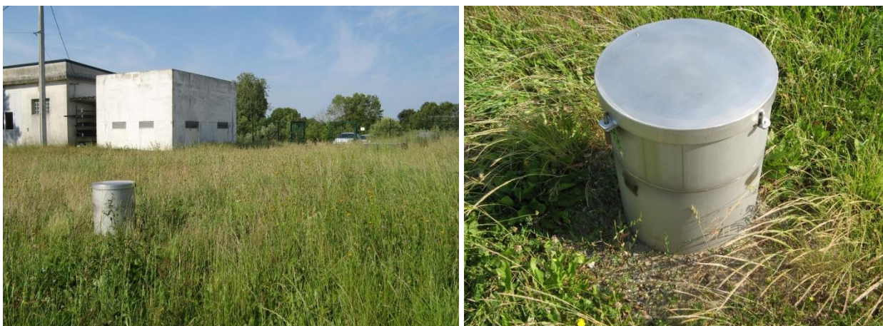
Illustration 53 - Vritz-Candé, photos du forage de reconnaissance (BRGM, 2015)
