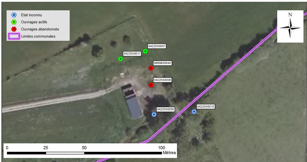
Illustration 55 – Vritz-Candé, site de la Kiriaie, Etat des points existants à proximité de l'ouvrage AEP
